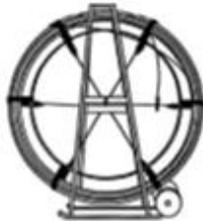
Figure E Disposition des chaînes utilisées pour le nettoyage des conduits
